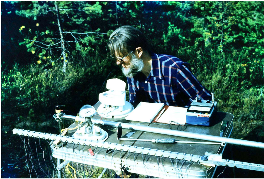
Foto 5. Juhan Ross Soome, Karjala ja Eesti ühisuuringuga „Puude ökofüsioloogia ja taigavööndi metsade energia- ning massivahetus“ seotud mõõtmistel Kentajärvil augustis 1979. Rossi töölaual oleval latil on Soome kolleegide valgussensorite rida. Läbipaistva kupliga sensor on termoelektriline püranomeeter, millega saab mõõta summaarset valgustatust. Parasjagu vaatab Ross galvanomeetri näitu, see näitab püranomeetri signaali. Latil kardaanil on LiCor-i fotosünteesiliselt aktiivse kiirguse sensor. Selle jaoks on laual Rossi vasaku käe juures oma elektroonikaplokk. Et mõõta püranomeetriga taeva hajuskiirgust, varjutati otsene päikese kiirgus laual varda küljes oleva ekraaniga.
